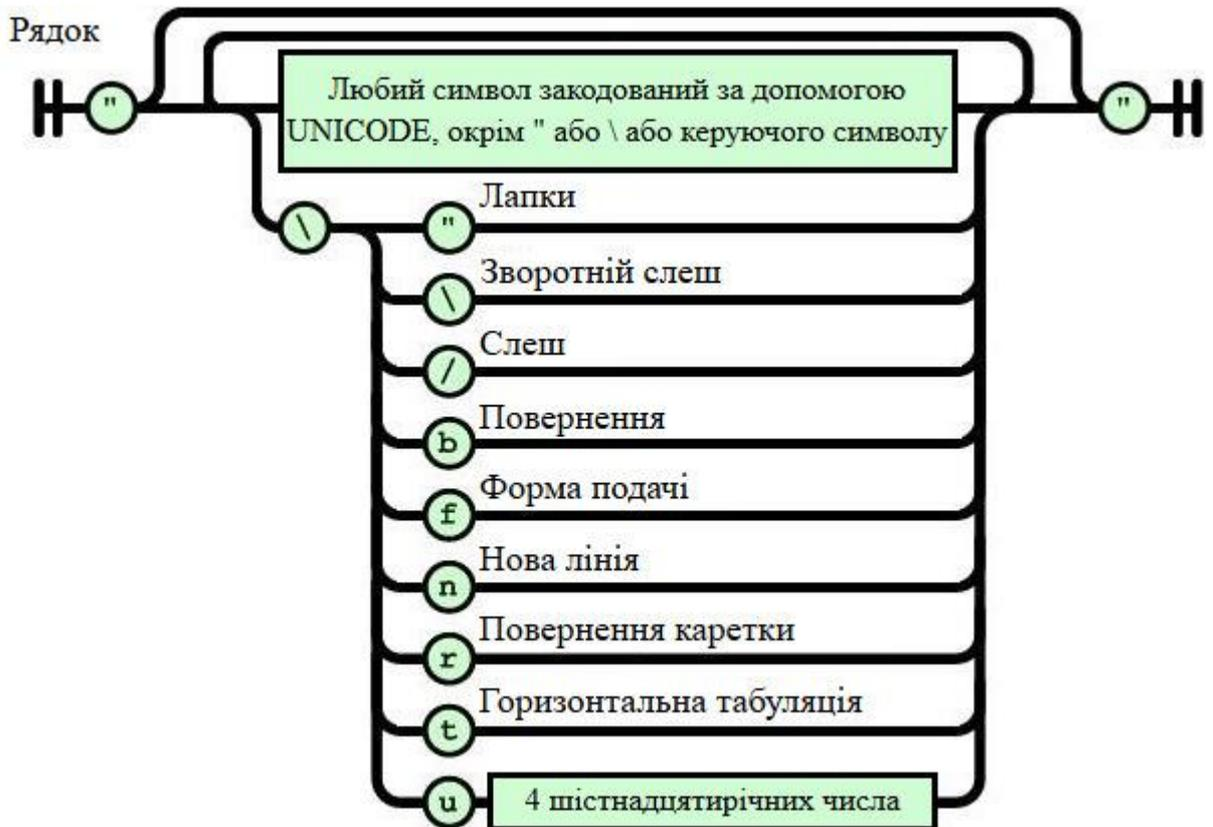
Рисунок 5.5.3.4 – Схематическое представление строки в JS
